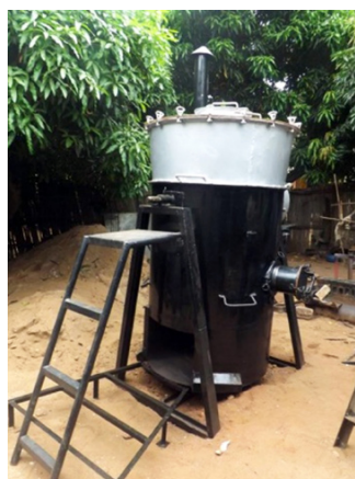
Figures 5b : Récent dispositif amélioré muni de foyer. Capacité d'étuvage 180 kg de paddy par traitement en 1h10 environ.
