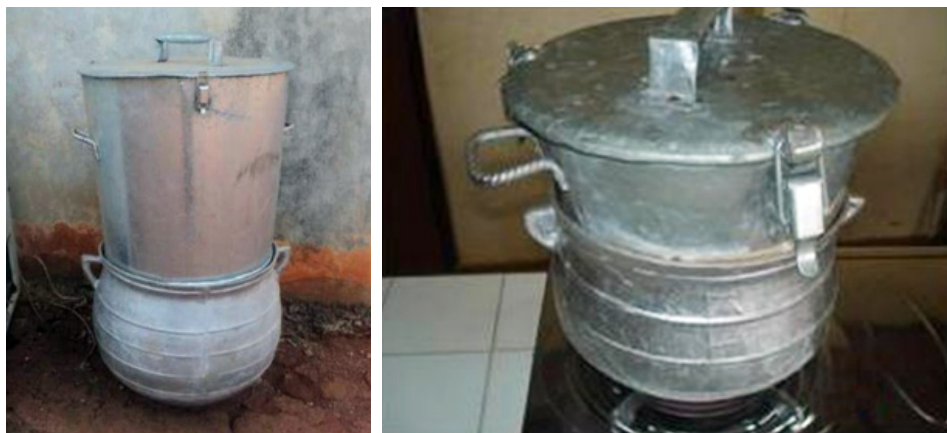
Figures 5a : 1er Dispositif marmite + bac. Capacité d'étuvage variable entre 10 à 80 kg de paddy par traitement en 30 min environ
