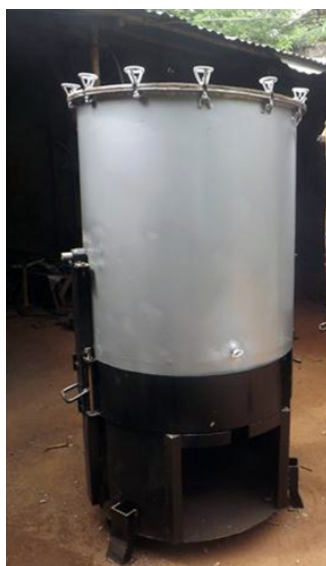
Figures 5b : Récent dispositif amélioré muni de foyer. Capacité d'étuvage 180 kg de paddy par traitement en 1h10 environ.
